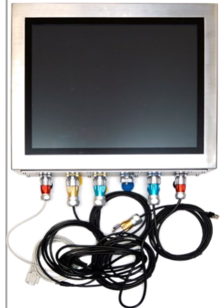
IQ-FlatMan™ AR190 Multitouch Panel PC Frontseite IP69 aus gehärtetem Glaslaminat - rundum IP67 - Gehäuse aus gebürsteten Edelstahl.
